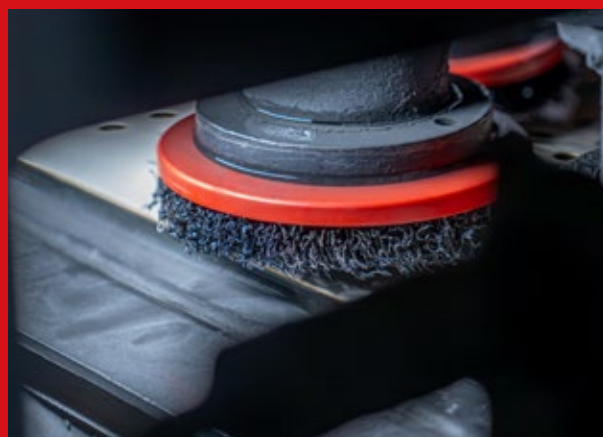
Entgratteller der SYNTHETIC EDITION auf dem Planetenkopf einer Nassentgratmaschine.
